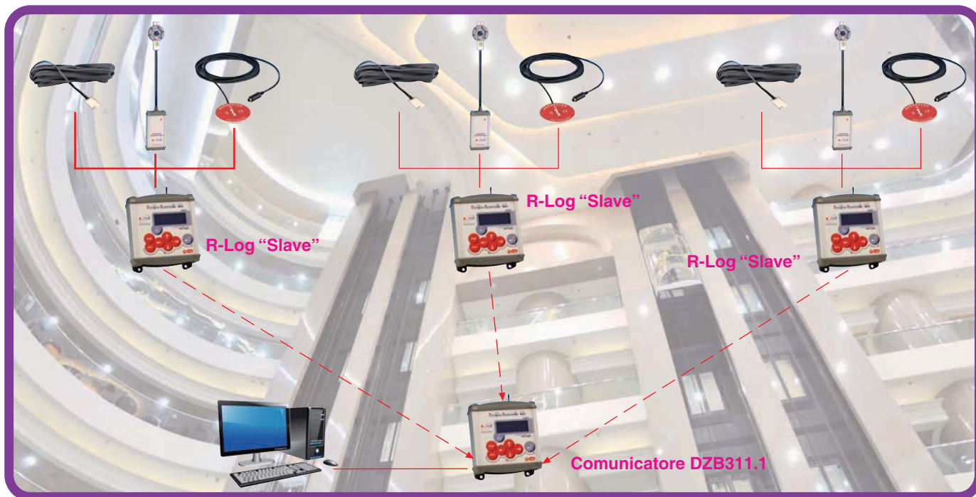
Modelli di Comunicatori con uscita seriale RS232 (EZB311.1) per connessione diretta a PC
